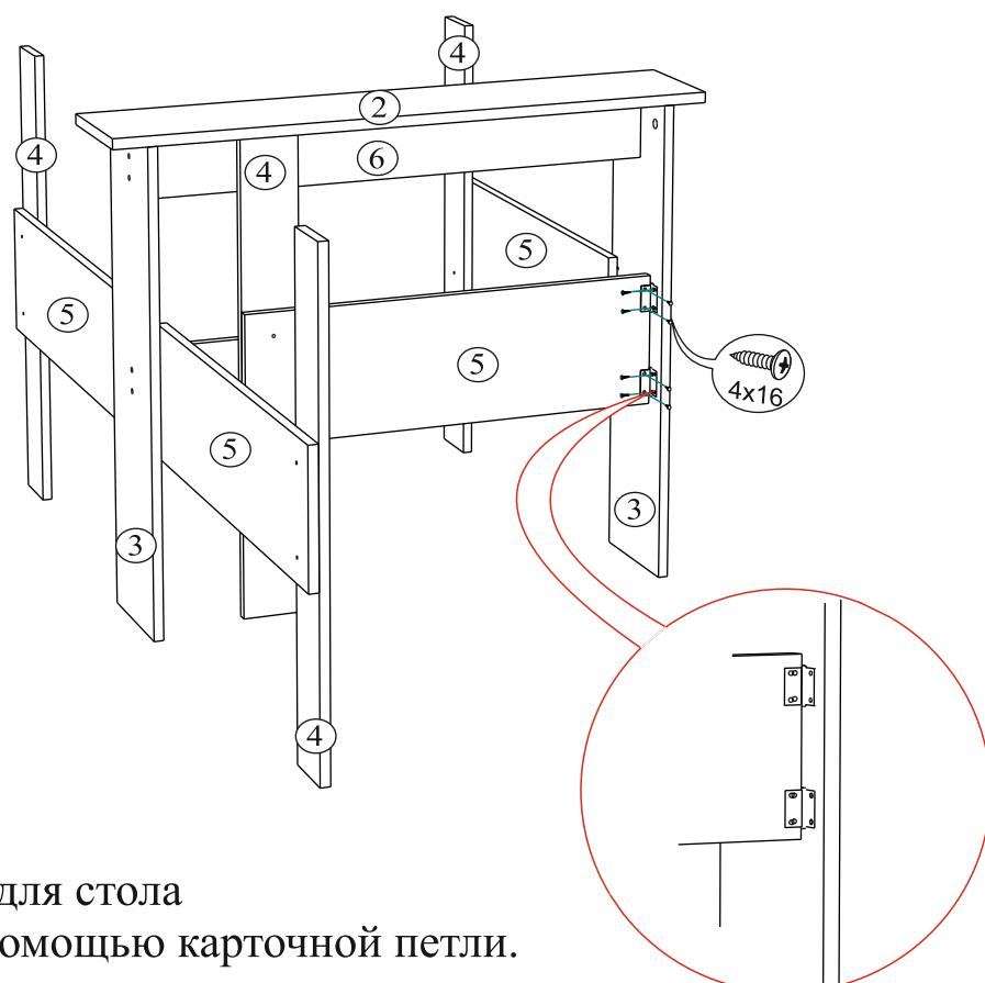
Прикручиваем опоры для стола
