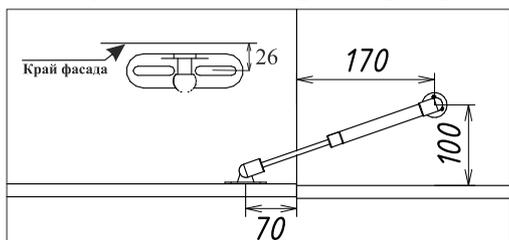
При креплении кронштейна секретерного к перегородке 13 и фасаду 16 использовать шурупы 4x16.
