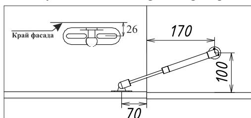
При креплении кронштейна секретерного к перегородке ⑬ и фасаду ⑯ использовать шурупы 4x16.
