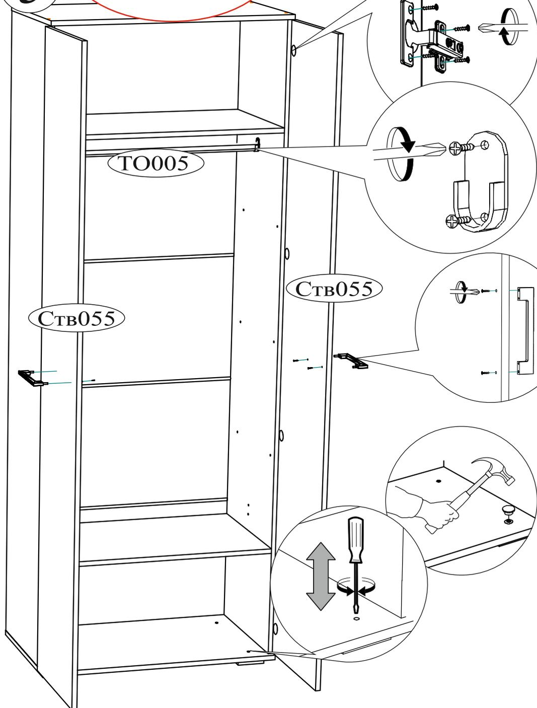
Регулировка створки по глубине
