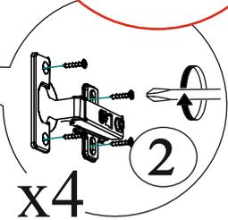
Регулировка створки по глубине
