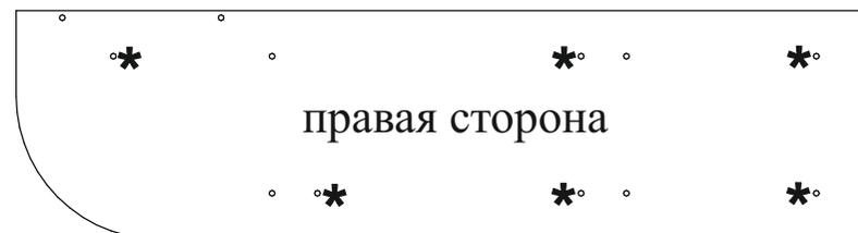
\* - отверстия для регулировки опор
