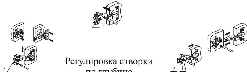
Регулировка створки по глубине
