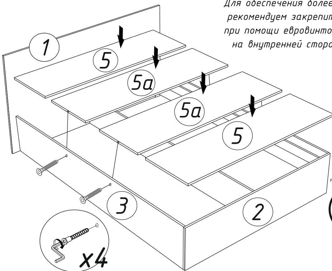
Для обеспечения более жесткой конструкции рекомендуем закрепить проложки к царгам при помощи евровинтов, для этого в царгах на внутренней стороне сделаны намётки.
