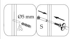
При наличии рядом стоящего модуля рекомендуем выровнять и скрепить их между собой межсекционной стяжкой, это придаст дополнительную жесткость всей конструкции. Предварительно необходимо просверлить отверстия Ø5 мм.
