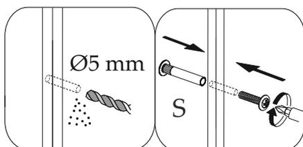
При наличии рядом стоящего модуля рекомендуем выровнять и скрепить их между собой межсекционной стяжкой, это придаст дополнительную жесткость всей конструкции. Предварительно необходимо просверлить отверстия Ø5 мм.
