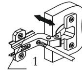
Регулировка створки по глубине
