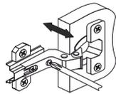
Регулировка створки по глубине
