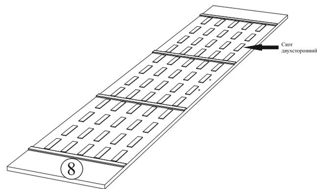
Рис.2 Схема наклейки зеркал на створку №8.
