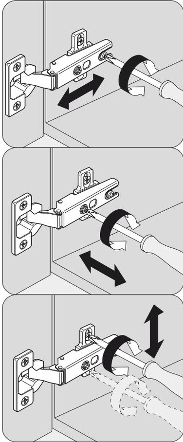
Схема регулировки петель
