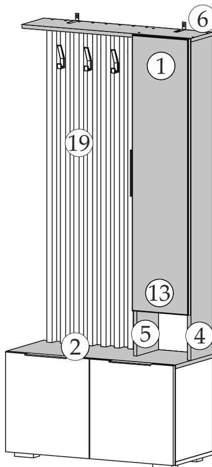
Детали № 1, 2, 6 с универсальной сверловкой, поэтому в зависимости от стороны сборки их можно переворачивать на 180 градусов, детали 4, 5, переставляются в зависимости от выбранной стороны сборки.
