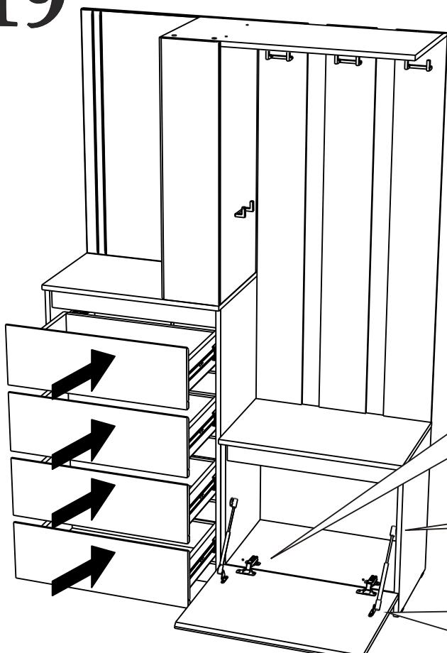
Схема установки газлифта секретерного
