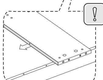
торцевые отверстия на детали 10 должны быть обращены в сторону свободных отверстий на детали 7
