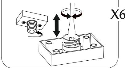
! Регулировка опор производится плоской отверткой через сквозные отверстия в крышке поз. 6.
