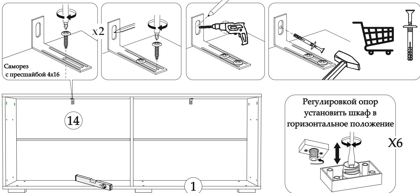
Регулировка опор производится плоской отверткой через сквозные отверстия в дне тумбы поз. 1.
