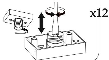
Регулировка опор производится плоской отверткой через сквозные отверстия в вязке поз. 3.
