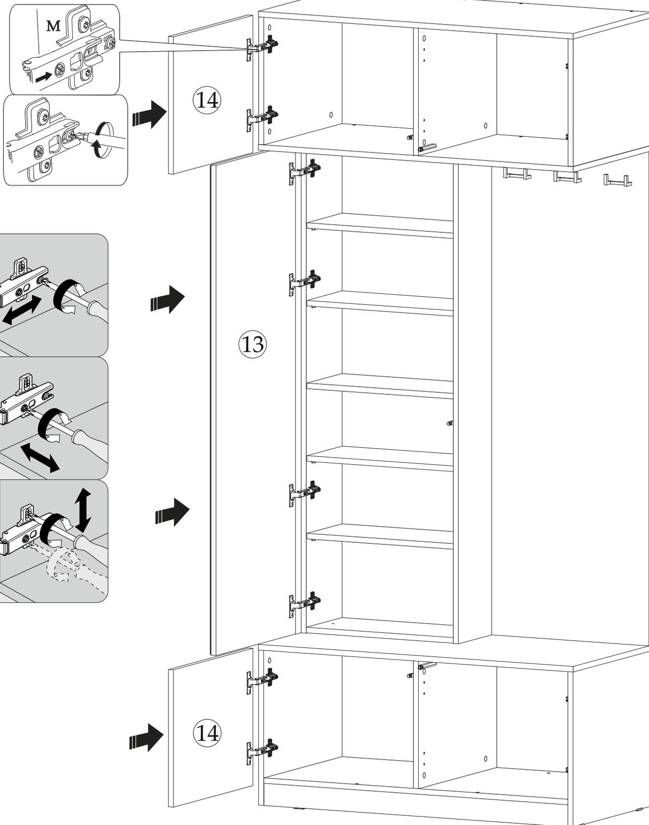
Схема регулировки петель
