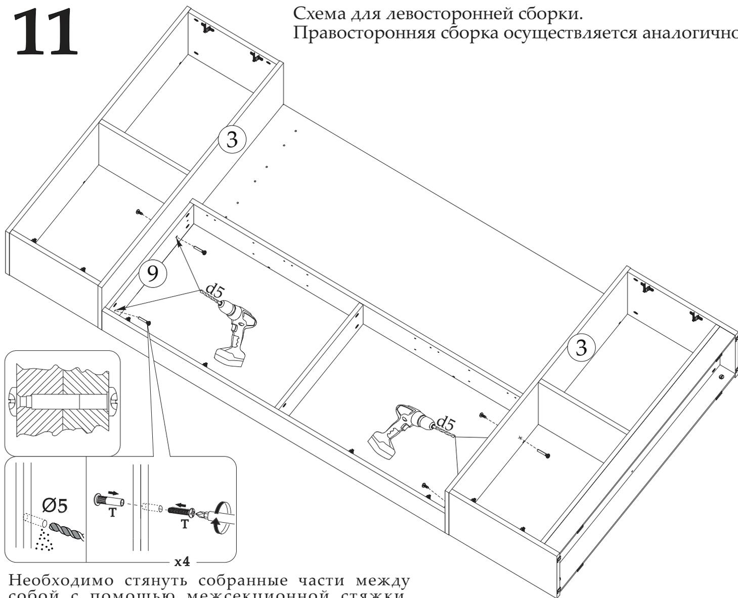
Необходимо стянуть собранные части между собой с помощью межсекционной стяжки, предварительно просверлив сквозные отверстия-Ø 5
