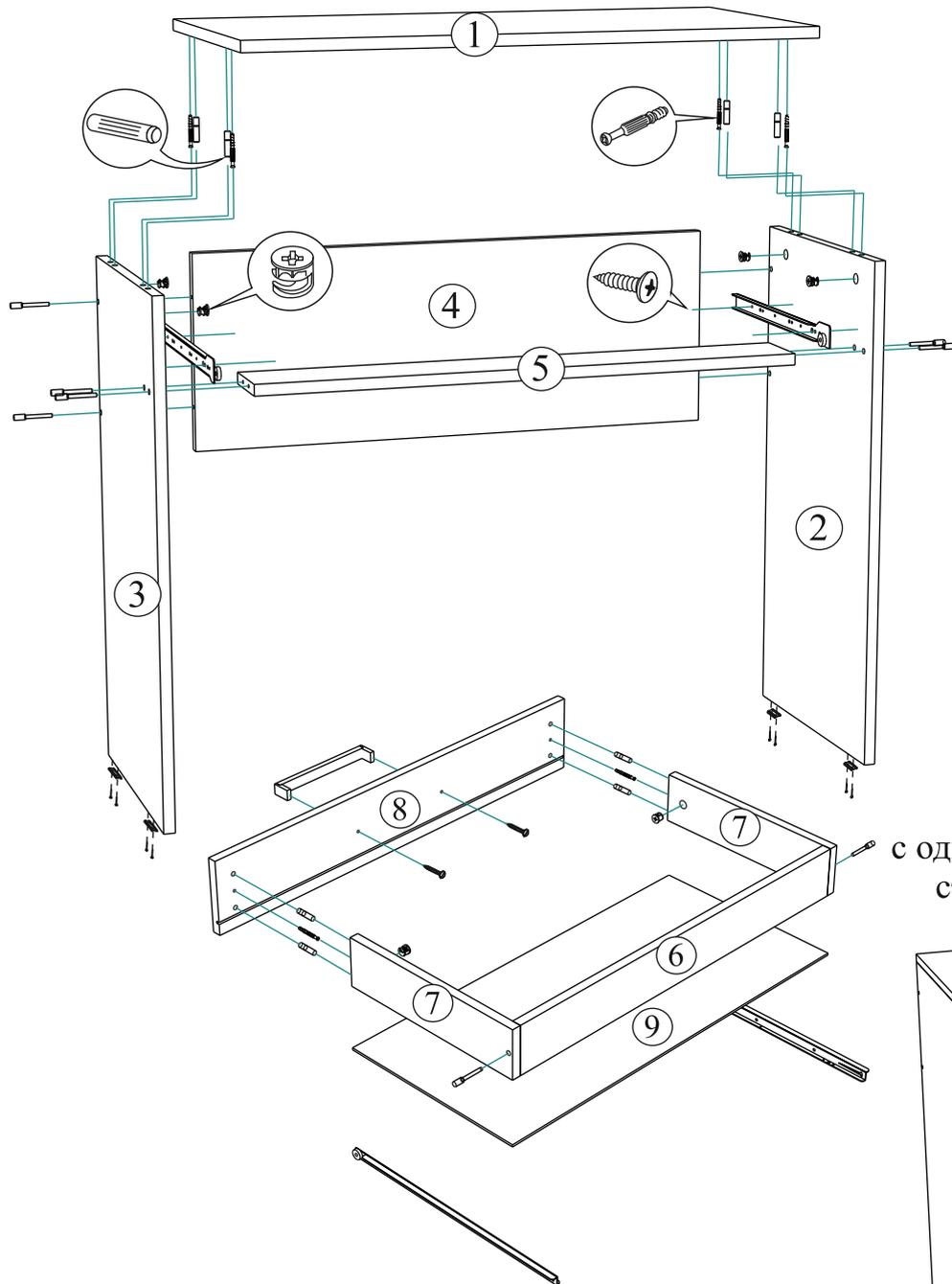
Для правильного открывания ящиков, необходимо выровнять диагонали каркаса ящика (Рис.1) и только потом прибить ЛДВП не нарушая диагонали.
