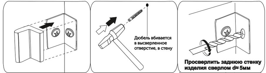
Просверлить заднюю стенку изделия сверлом  $\varnothing 5\text{мм}$
