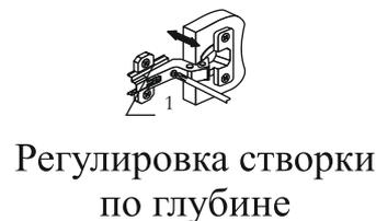
Регулировка створки по глубине
