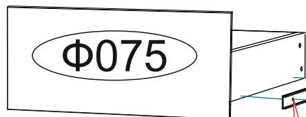
*Шариковые направляющие крепятся снизу боковины и плотную к фасаду.*
