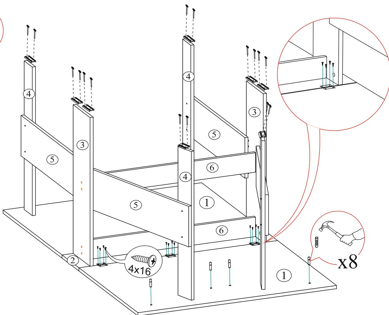
Для удобства дальнейшей сборки переворачиваем стол и прикручиваем крышки №1 к крышке №2.
