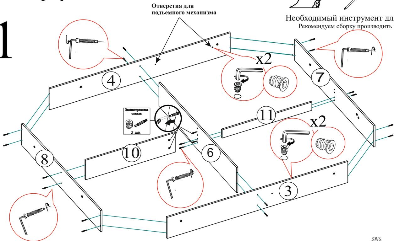
Отверстия для подъемного механизма
