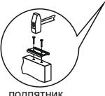
Направляющая СТ прикручивается на стяжки межсекционные 15 мм и дополнительно фиксируется шурупами 4x16
