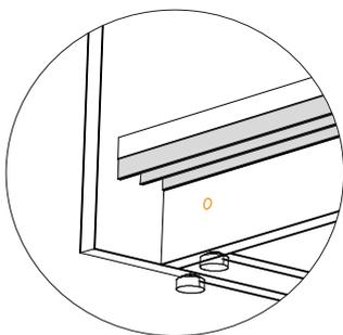
Нижняя направляющая устанавливается вровень с вязкой, дополнительно фиксируется шурупами 4x16
