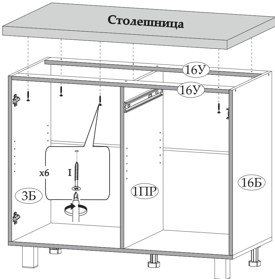
**Схема установки столешницы**
