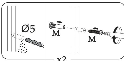
При наличии рядом стоящего изделия необходимо стянуть их между собой с помощью межсекционной стяжки, предварительно просверлив сквозные отверстия Ø 5
