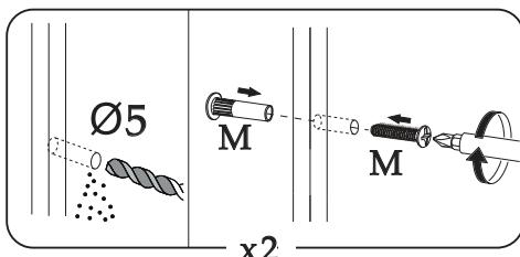
При наличии рядом стоящего изделия необходимо стянуть их между собой с помощью межсекционной стяжки, предварительно просверлив сквозные отверстия  $\varnothing 5$
