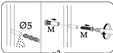
При наличии рядом стоящего изделия необходимо стянуть их между собой с помощью межсекционной стяжки, предварительно просверлив сквозные отверстия-Ø 5
