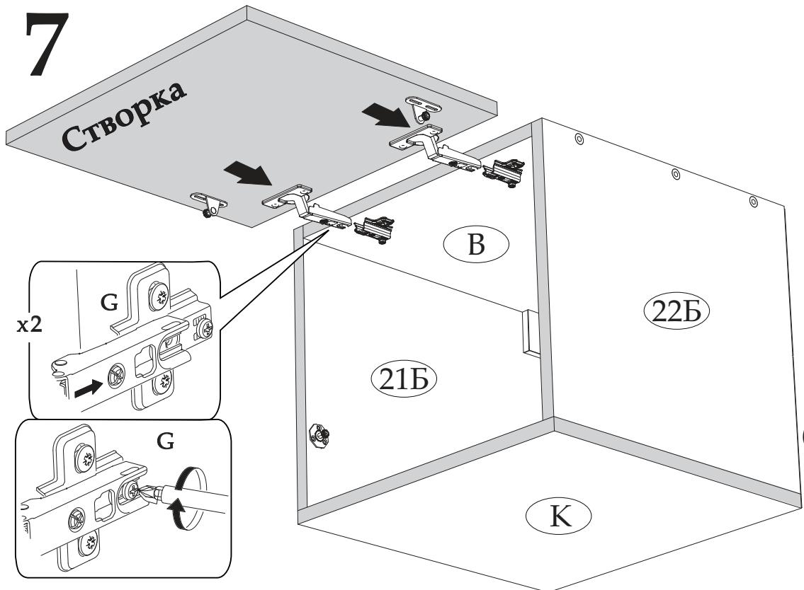
Схема регулировки петель
