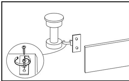
Для всех нижних секций предусмотрена возможность установки цоколя, для этого в комплекте фурнитуры заложены клипсы к опоре (черная), которая в этом случае крепится впереди и цоколь монтируется согласно схеме.
